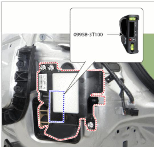
11. 测量左右BCW模块的水平和垂直角度。如果测量值偏离规定值,请在BCW模块的支架之间插入垫片(A)。
